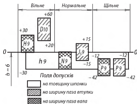
Рис. 5.2. Поля допусків шпонкових з'єднань
