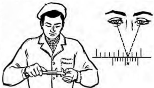
Рис. 2.37. Під час читання показань штангенциркуля слід тримати прямо перед очима
