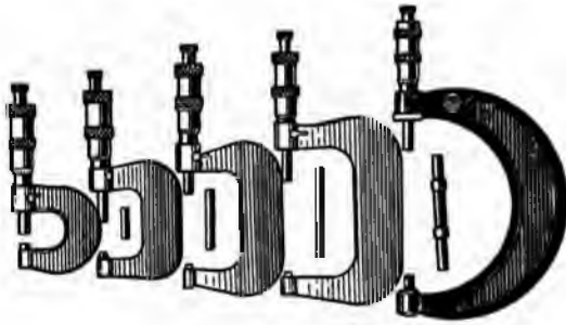
Рис. 2.50. Мікрометри типу МК
