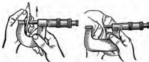
Рис. 2.66. Протирання вимірювальних поверхнь
