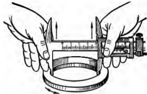
Рис. 2.44. Перевірка на відчуття вимірювального зусилля при вимірюванні великого внутрішнього діаметра
