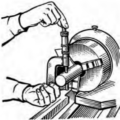
Рис. 2.79. Вимірювання деталі, закріпленої в патроні верстата
