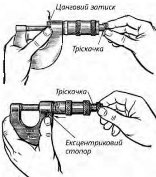
Рис. 2.69. Закріплення мікрогвинта стопором
