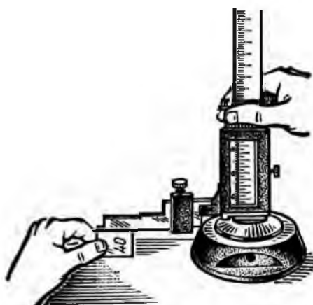
Рис. 2.48. Перевірка нульового положення штангенрейсмаса
