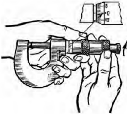
Рис. 2.71. Установка барабана і його закріплення
