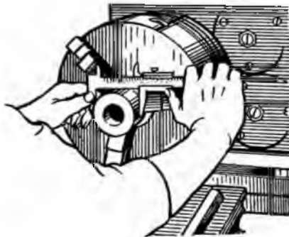
Рис. 2.34. Положення рук щодо верстата, штангенциркуля і закріпленої деталі
