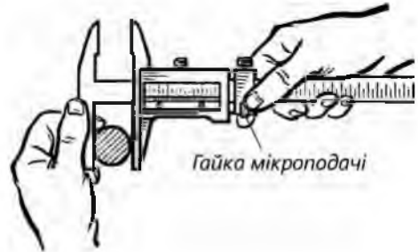
Рис. 2.42. Обертання гайки мікрометричної подачі
