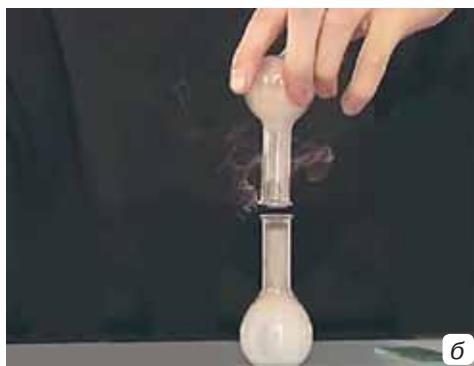
Мал. 10 Взаємодія амоніаку з гідроген хлоридом: а — колби з реагентами; б — утворення амоній хлориду
