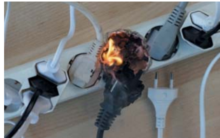
Рис. 8.3. Перевантаження за паралельного з'єднання споживачів електричного струму
