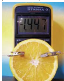
Рис. 7.4. Саморобне хімічне джерело струму
